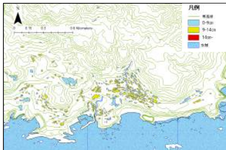
図 5-16 足摺岬エリアの木造住宅被害 (海溝型地震・東北地方太平洋沖地震)
