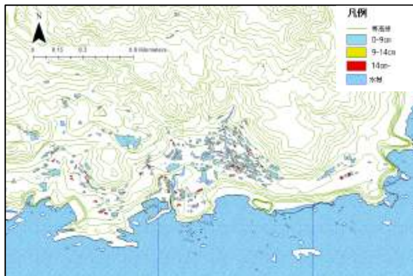
図 5-13 足摺岬エリアの木造住宅被害 (内陸地震・熊本地震益城観測点)
