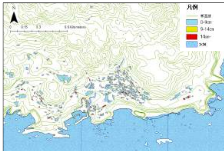
図 5-12 足摺岬エリアの木造住宅被害 (内陸地震・新潟中越沖地震)
