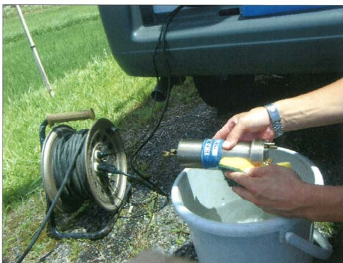
St. 1 (三崎川河口) 濁度計 センサー清掃点検状況
