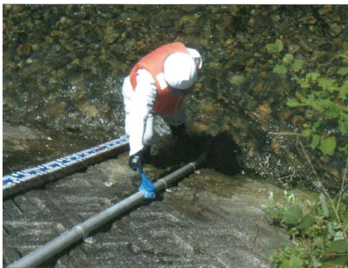
St. 2 (三崎川) センサー保護管清掃状況
