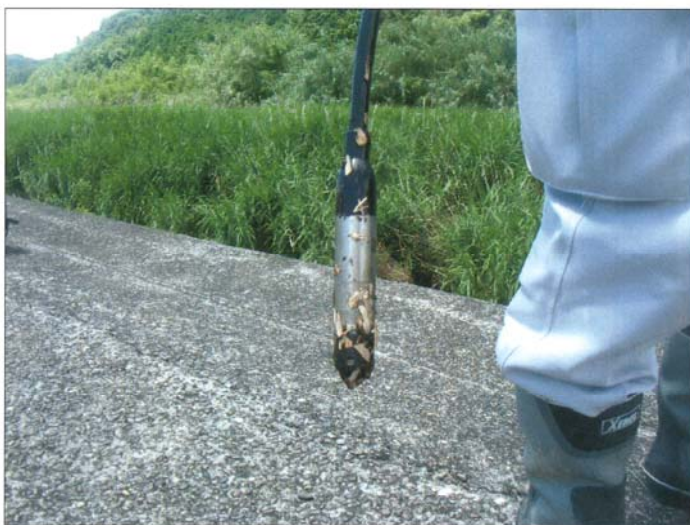
St. 2 (三崎川) 水位計 センサー点検前
