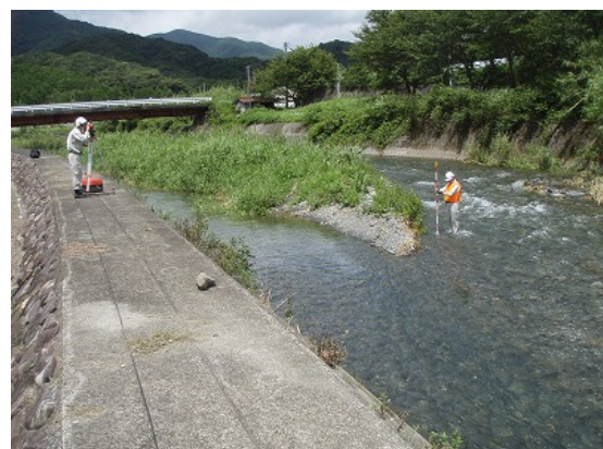
断面測量状況
