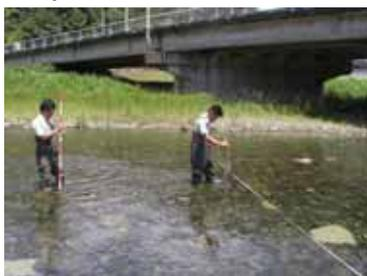
流速計による流量観測状況
