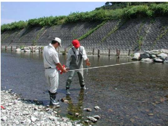
流速計による流量観測状況
