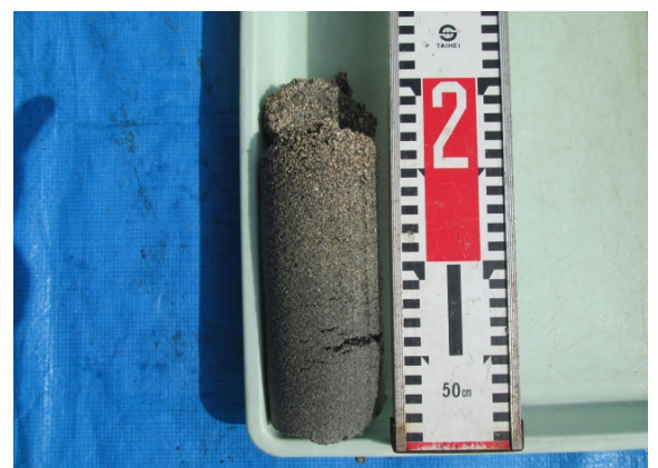
写真 14 測点⑦ 柱状採泥試料 状態
