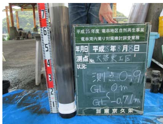
写真 39 大碓 0-9 柱状採泥試料
