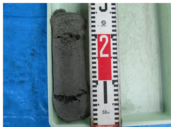
写真 14 測点⑦ 柱状採泥試料 状態
