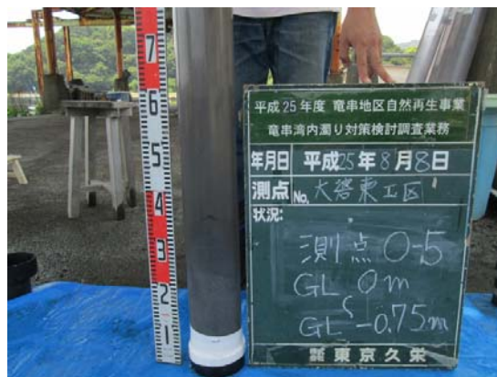
写真 35 大碓 0-5 柱状採泥試料
