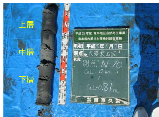
写真 32 大碓 N-10 柱状採泥試料 状態
