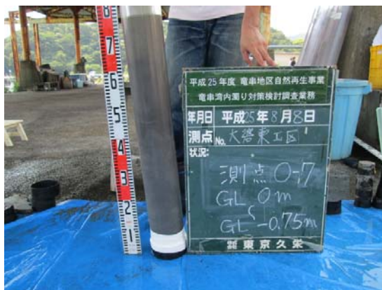
写真 37 大碓 0-7 柱状採泥試料
