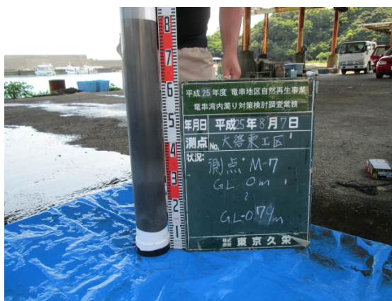
写真 5 測点③(M7) 柱状採泥試料
