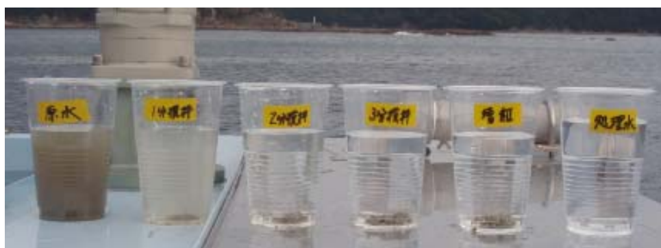
写真 4-3-37 実証試験攪拌による処理水
