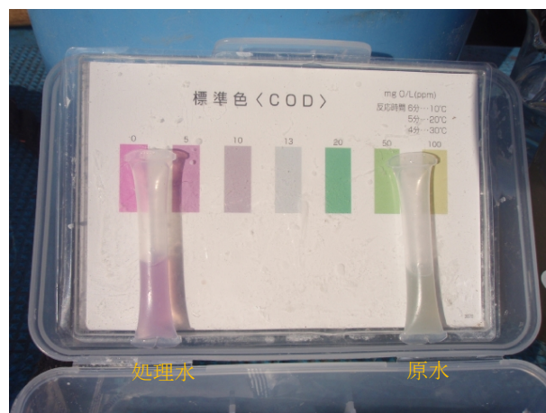
写真 4-3-33 COD 試験（原水及び処理水）
