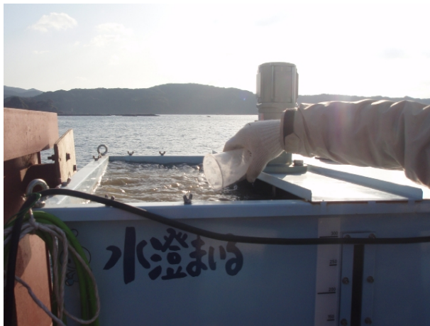
写真 4-3-24 小型排水処理装置 粉体凝集剤投入状況
