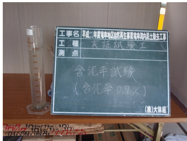
写真 4-3-31 含泥率試験（原水）
