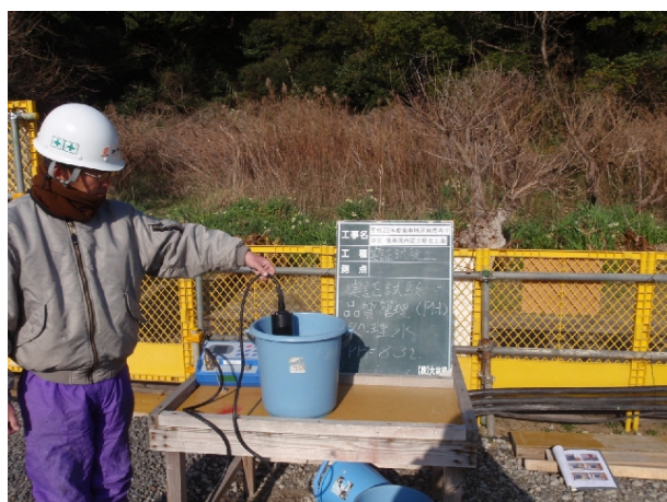
写真 4-3-32 濁度及び pH 試験状況（原水及び処理水）
