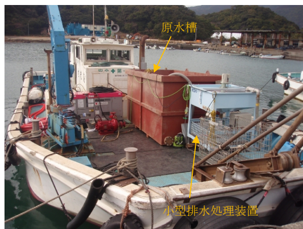
写真 4-3-9 実証試験装置艀装完了
