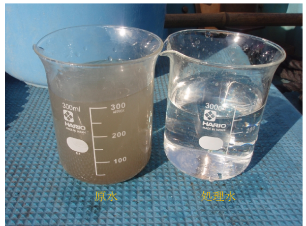
写真 4-3-27 小型排水処理装置 原水及び処理水
