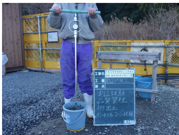
写真 4-3-34 ポータブルコーン試験（排出土）
