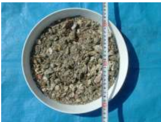
写真 2-6-23 乾燥後底質状態 泥土除去後
