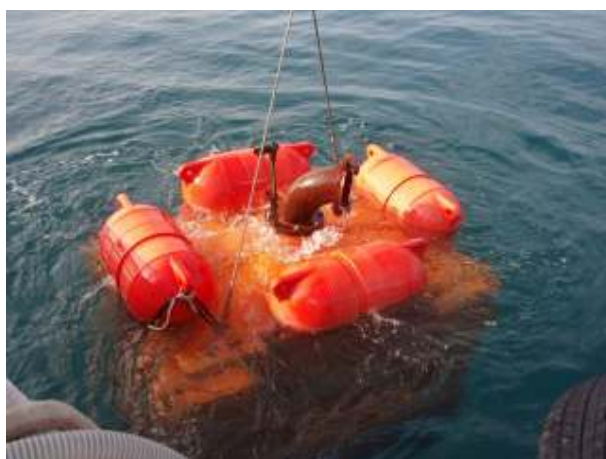
写真 2-6-3 現位置分級器投入状況
