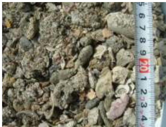
写真 2-6-24 乾燥後底質状態 泥土除去後
