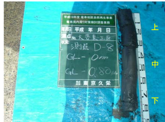
写真 4-1-24 D-8 上層から下層まで泥を中心とした堆積
