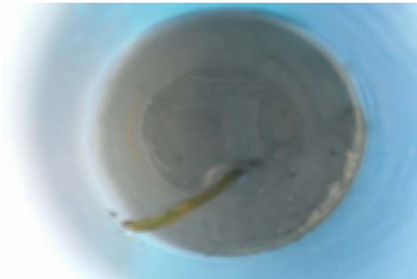
写真 98 弁天島 F-5 柱状採泥試料 状態
