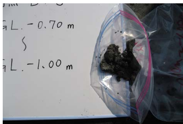
写真 52 大礫 D-5 検土杖採泥試料 状態 GL. -0.70 m ~ -1.00 m
