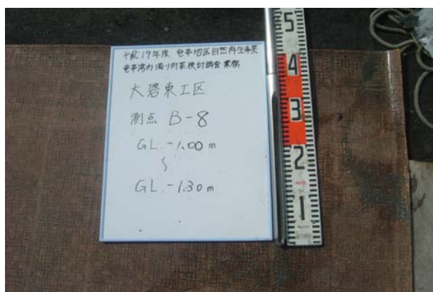
写真 91 大礫 B-8 検土杖採泥試料 GL. -1.00 m ~ -1.30 m
