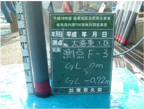
写真 35 大碓 F-3 柱状採泥試料
