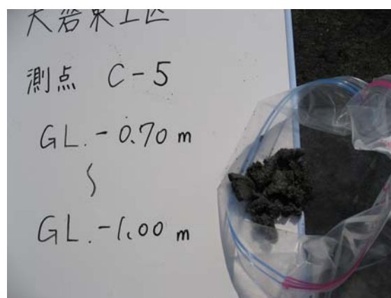
写真 4-1-30 C-5 砂を中心とした底質
