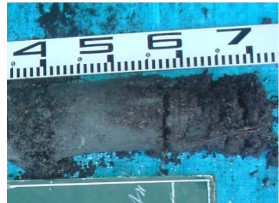
写真 4-1-28 C-8 ②拡大 砂混じり泥の中に 木片、葉片が混在
