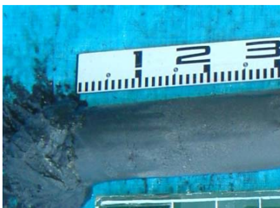
写真 4-1-27 C-8 ①拡大 表層(10cm)に粘土の堆積
