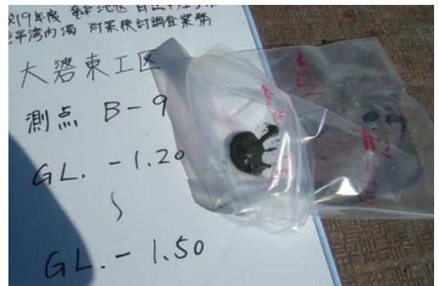
写真 108 大碇 B-9 検土杖採泥試料 状態 GL. -1.20 m ~ -1.50 m
