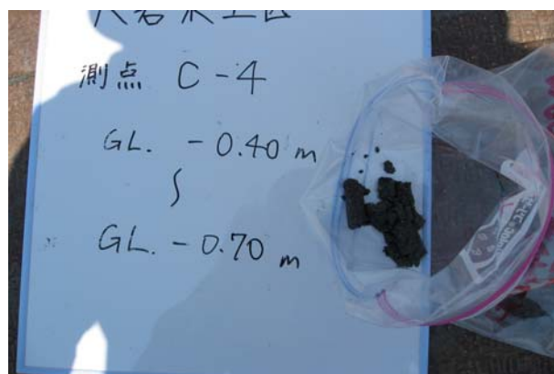
写真 40 大礮 C-4 検土杖採泥試料 状態 GL. -0.40 m ~ -0.70 m
