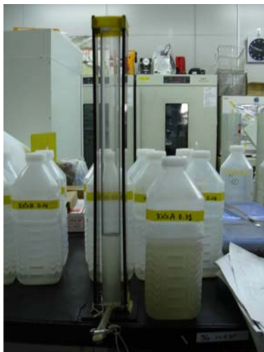
写真 4-2-6 透視度測定状況（50cm 透視度計使用）
