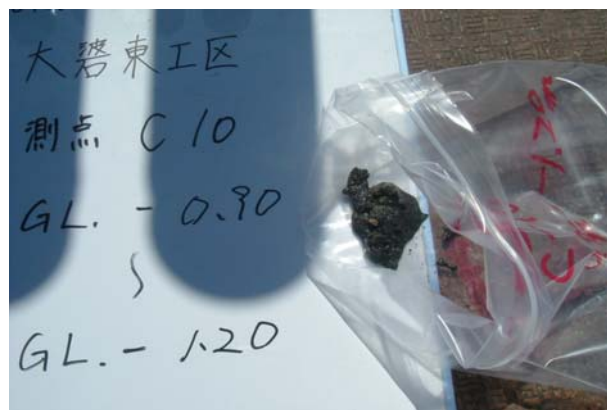
写真 116 大礮 C-10 検土杖採泥試料 状態 GL. -0.90 m ~ -1.20 m
