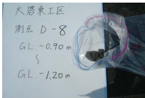
写真 100 大礫 D-8 検土杖採泥試料 状態 GL. -0.90 m ~ -1.20 m
