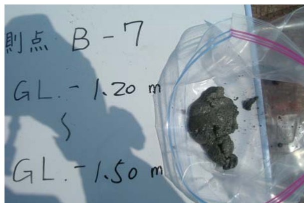
写真 78 大礫 B-7 検土杖採泥試料 状態 GL. -1.20 m ~ -1.50 m
