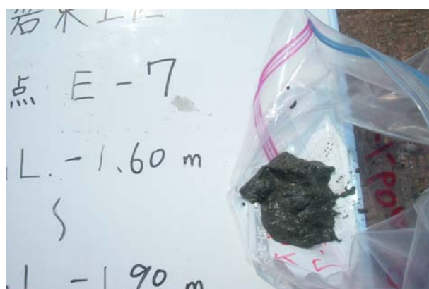
写真 88 大礮 E-7 検土杖採泥試料 状態 GL. -1.60 m ~ -1.90 m
