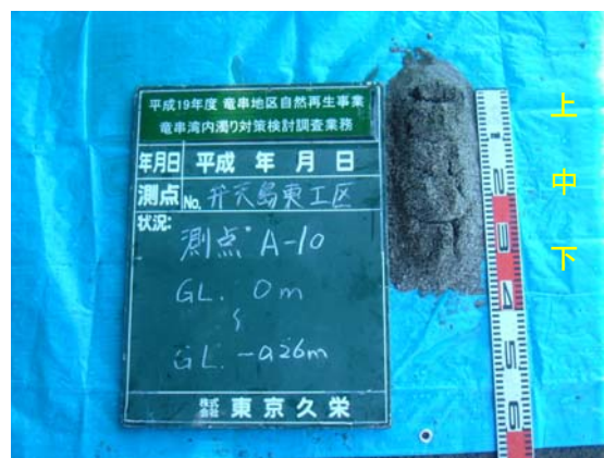
写真 4-1-10 A-10 一様に砂礫の堆積
