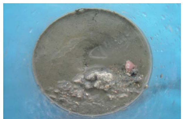
写真 38 弁天島 C-8 柱状採泥試料 状態
