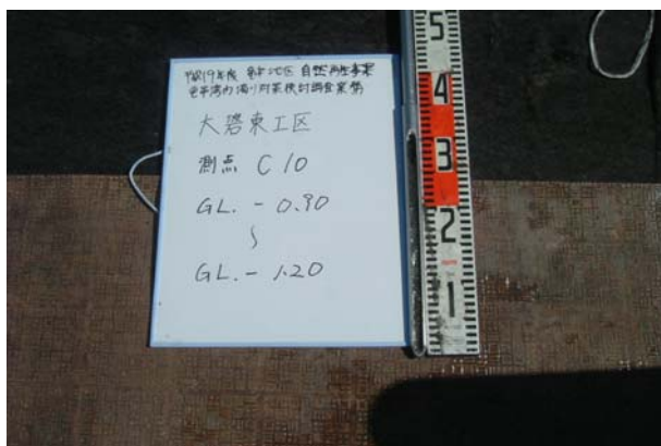
写真 115 大礮 C-10 検土杖採泥試料 GL. -0.90 m ~ -1.20 m
