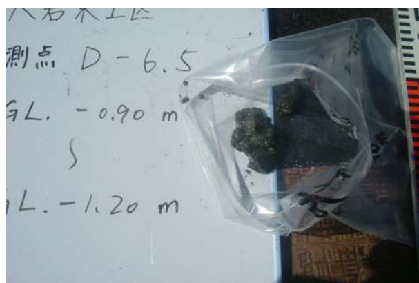
写真 74 大礫 D-6.5 検土杖採泥試料 状態 GL. -0.90 m ~ -1.20 m
