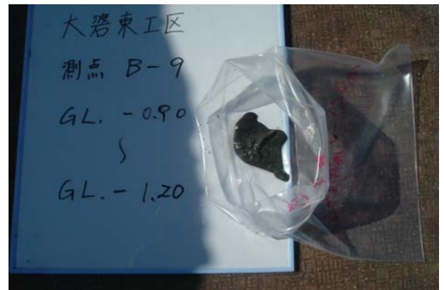
写真 106 大碇 B-9 検土杖採泥試料 状態 GL. -0.90 m ~ -1.20 m
