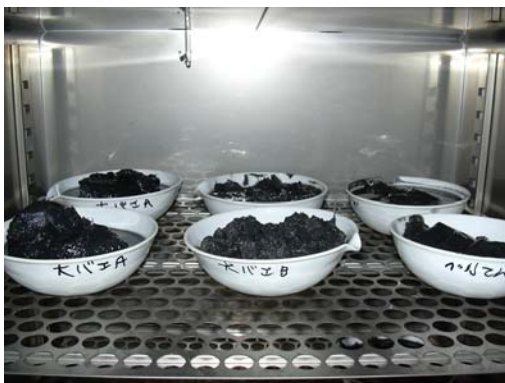
写真 4-2-1 試料を一晩乾燥状況
