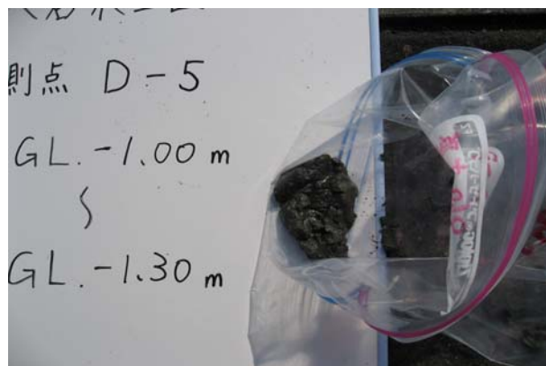
写真 54 大礫 D-5 検土杖採泥試料 状態 GL. -1.00 m ~ -1.30 m
