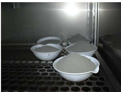
写真 4-2-3 2 時間乾燥し標準品作成状況
