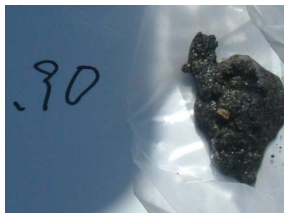
写真 4-1-34 C-10 木片、葉片混じりの底質
