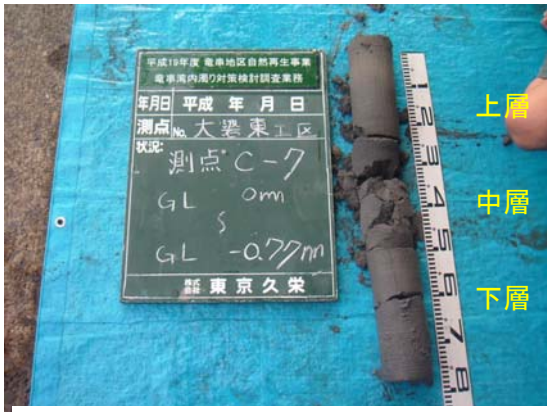
写真 74 大濠 C-7 柱状採泥試料 状態
