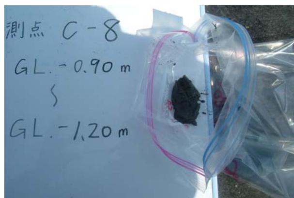
写真 96 大礫 C-8 検土杖採泥試料 状態 GL. -0.90 m ~ -1.20 m
