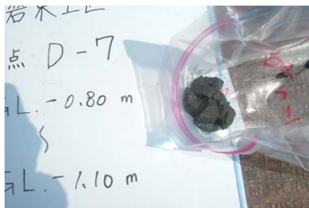
写真 80 大礫 D-7 検土杖採泥試料 状態 GL. -0.80 m ~ -1.10 m
