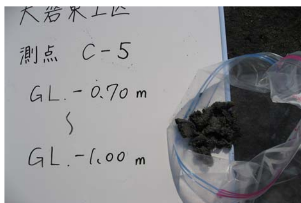
写真 50 大礫 C-5 検土杖採泥試料 状態 GL. -0.70 m ~ -1.00 m
