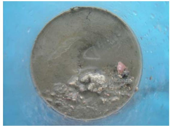
写真 4-1-12 C-8 表層に浮泥 その下にコーラル貝殻混じり砂の堆積
