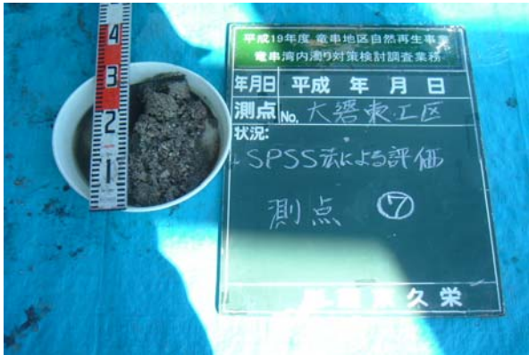
写真 14 測点⑦ 柱状採泥試料 状態
