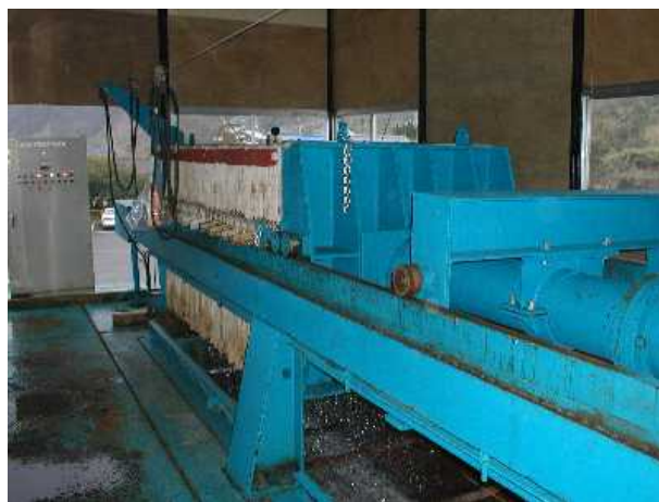
写真 3-6-27 圧入状況（脱水機）
