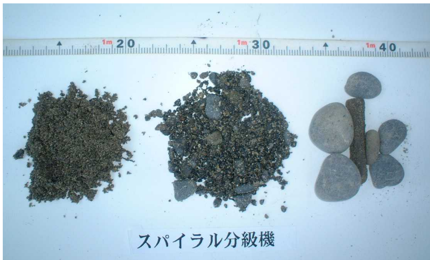
写真 3-7-4 分級後の粗粒分（スパイラル分級機）
