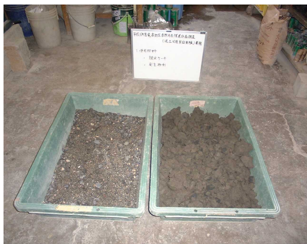
写真 3-6-42 有効利用試験試料（固化処理） （試料：浚渫土）
