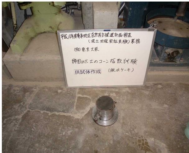
写真 3 - 6 - 50 コーン指数試験供試体 (試料：脱水ケーキ)
