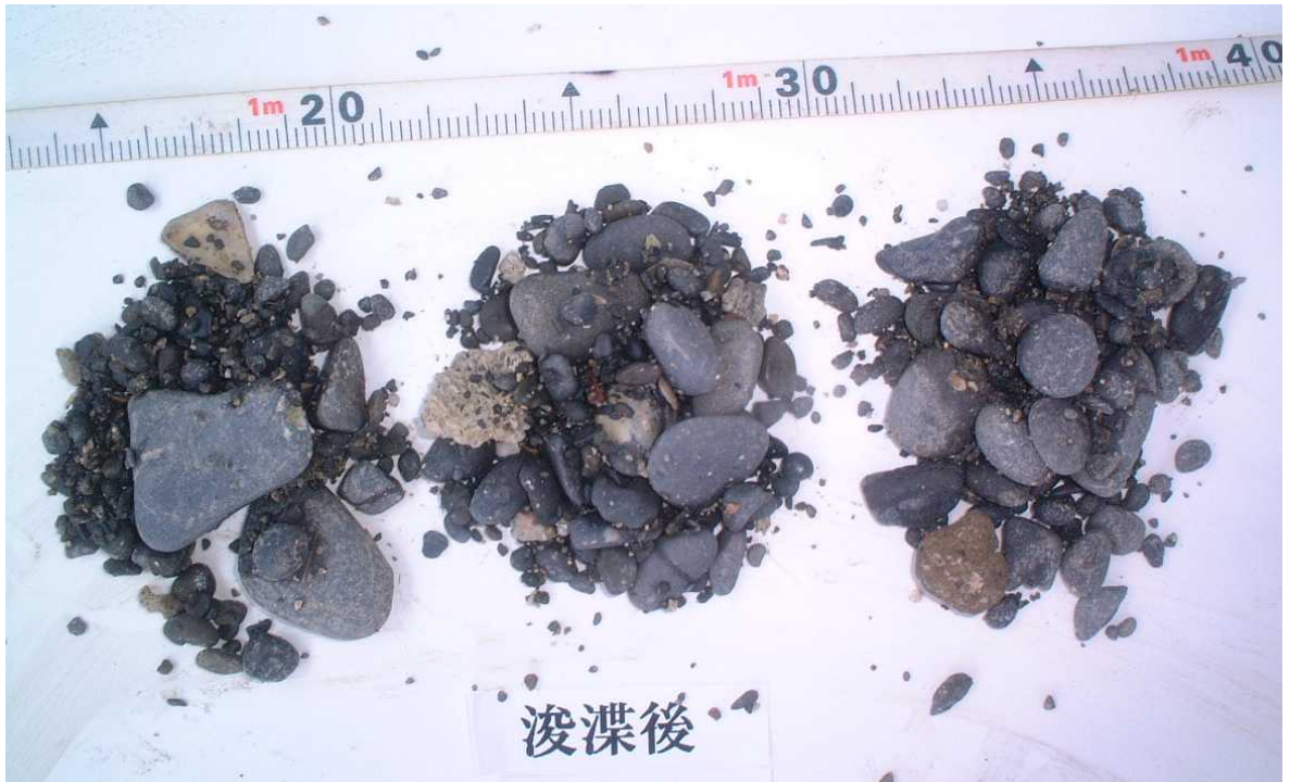
写真 2-5-44 浚渫後の表層土（ジェット併用Ⅰ型）；左から横1、中央、横2の試料
