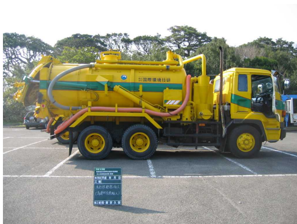
写真 3-6-40 高速吸引車 (水処理機器清掃時)
