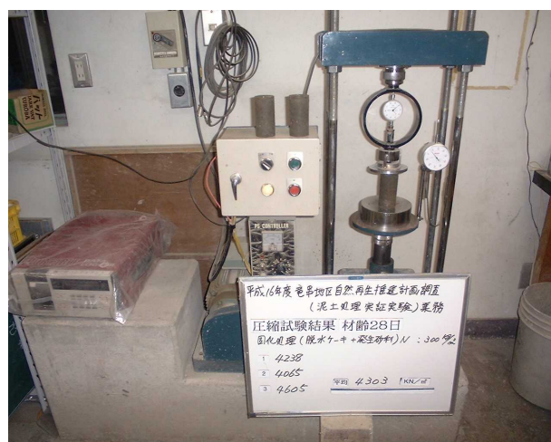
写真 3-6-44 一軸圧縮試験 （固化処理）
