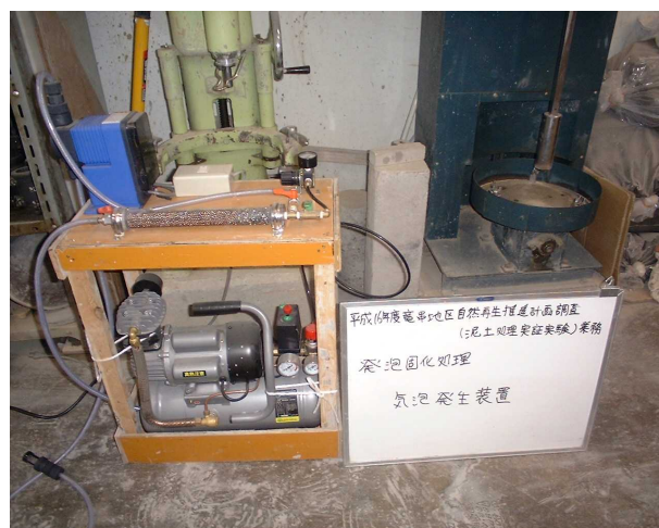
写真 3-6-45 気泡発生装置 （発泡固化処理試験）
