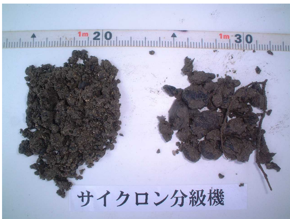
写真 3-7-5 分級後の粗粒分（サイクロン分級機）
