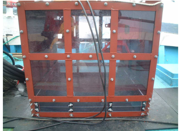
写真 2-5-13 ジェット併用Ⅰ型外観（監視窓）
