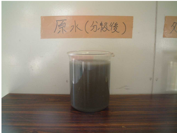
写真 3-6-36 原 水 (分級後の浚渫排水)
