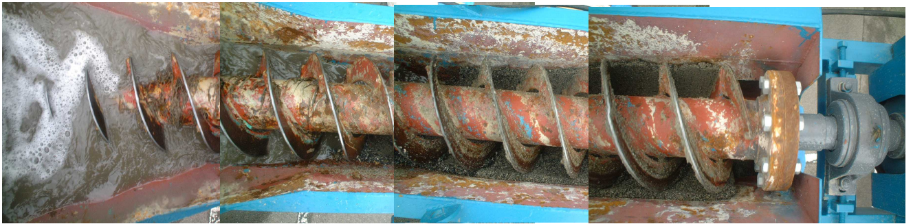
写真 3-6-9 処理状況（スパイラル分級機）
