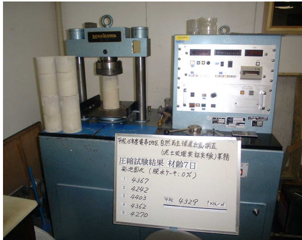
写真 3 - 6 - 48 一軸圧縮試験 (検体：発泡固化処理)
