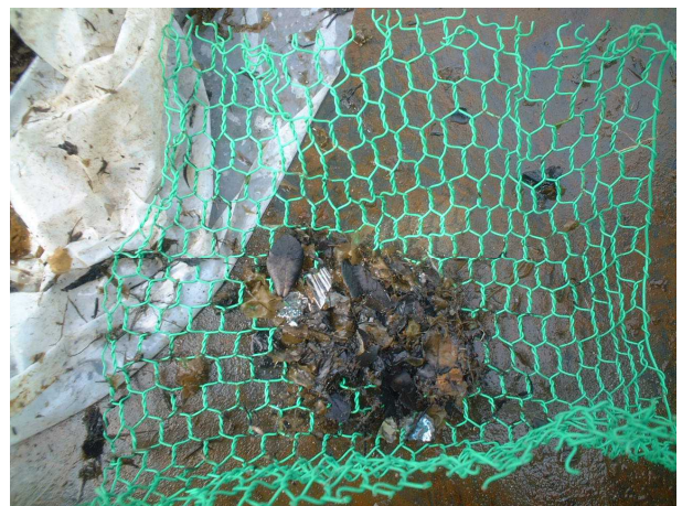
写真3-7-2 ポンプに詰まった混在物
