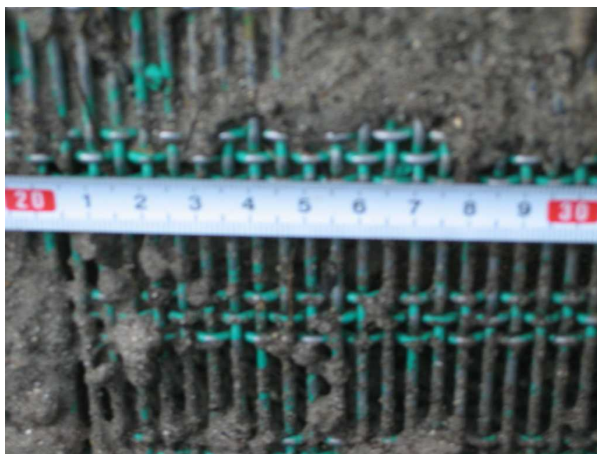
写真3-7-3 振動振るい部のメッシュ (5mm)
