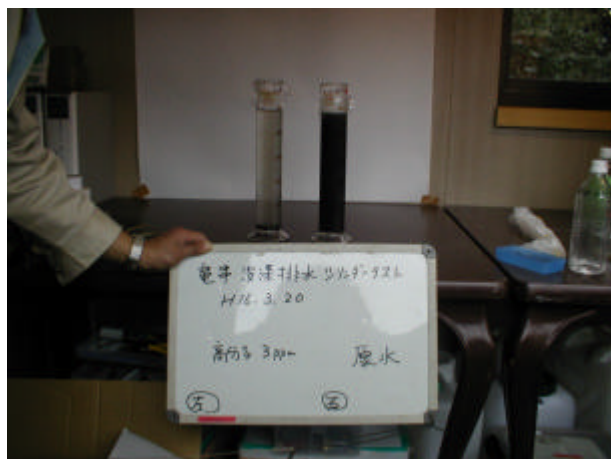
写真 3-5-39 テーブルテスト状況 (凝集テスト)
