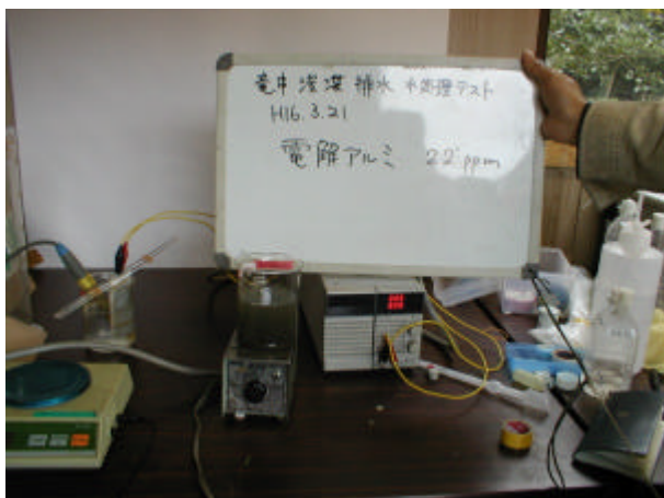
写真 3-6-11 テーブルテスト状況 (電解アルミニウム)
