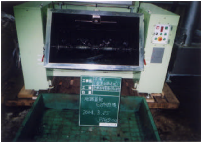
写真 4-4-9 発酵処理状況 (無薬注浚渫土・6 時間後)
