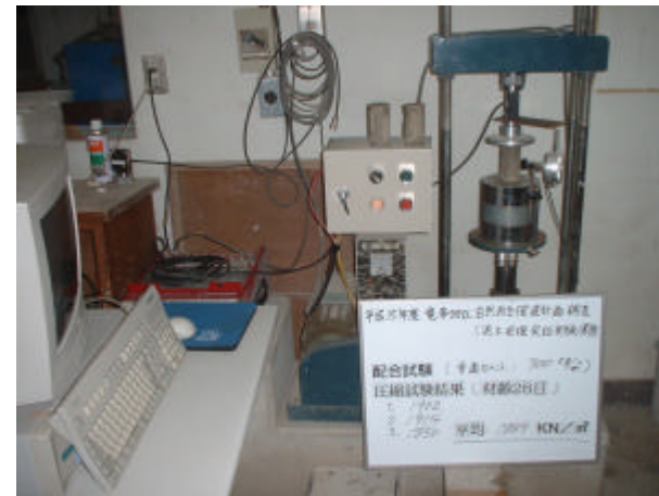
写真 4-3-18 一軸圧縮試験状況 (普通セメント、300kg/m³、材齢 28 日)
