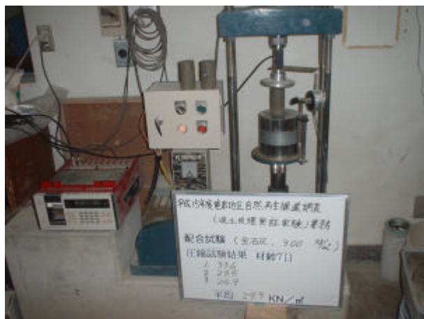
写真 4-3-14 一軸圧縮試験状況 (生石灰、300kg/m³、材齢 7 日)
