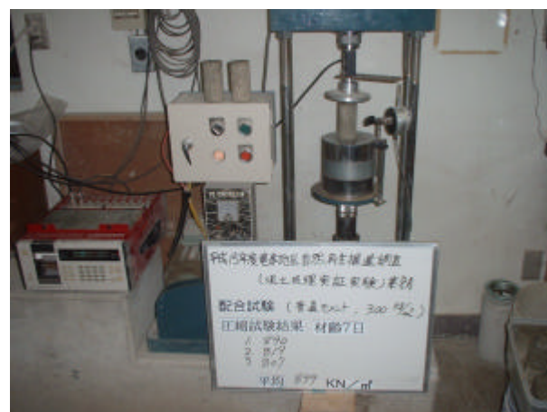
写真 4-3-12 一軸圧縮試験状況 (普通セメント、300kg/m³、材齢 7 日)
