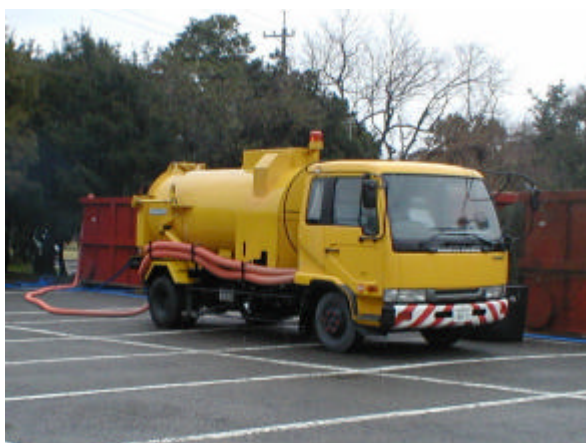
写真 3-7-1 土砂の回収状況 (バキューム車)
