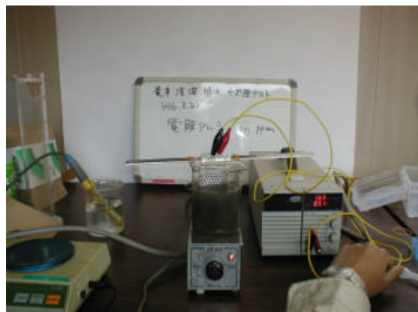
写真 3-6-12 テーブルテスト状況 (電解アルミニウム)
