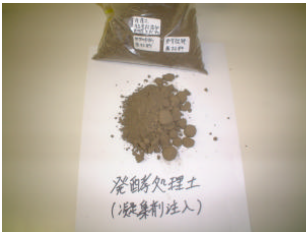
写真 4-4-19 発酵処理土 （薬注浚渫土）
