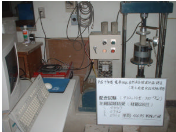
写真 4-3-19 一軸圧縮試験状況 (セメント系固化材、300kg/m 3 、材齢 28 日)
