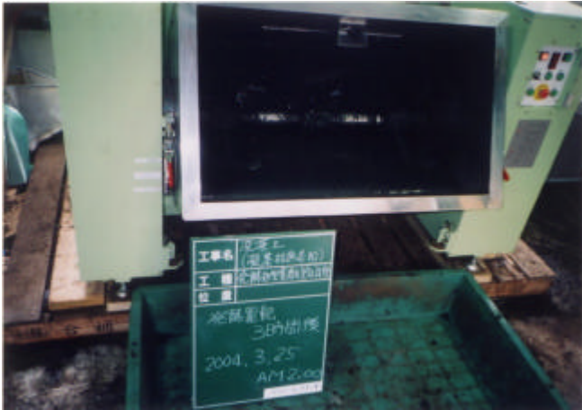
写真 4-4-7 発酵処理状況 (無薬注浚渫土・3 時間後)
