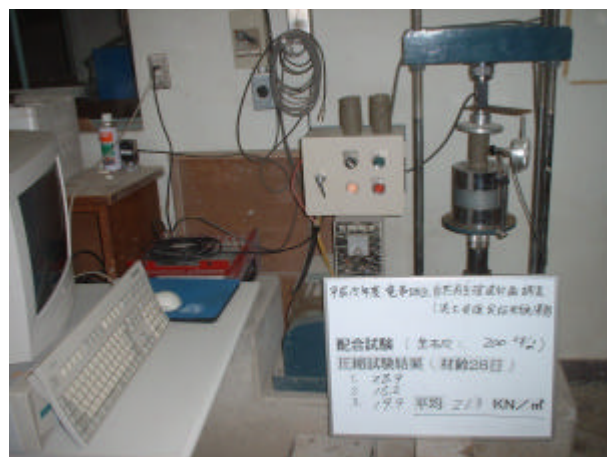
写真 4-3-17 一軸圧縮試験状況 (生石灰、200kg/m³、材齢 28 日)
