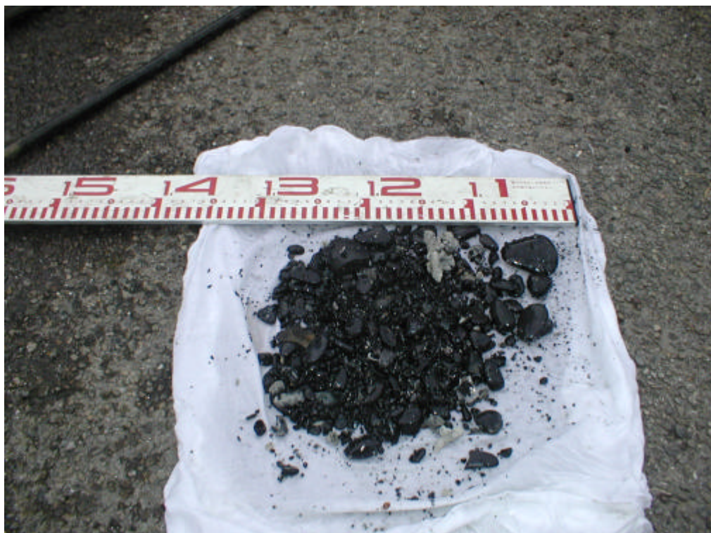
写真 2-3-28 堆積土砂状況(潜水土によるサンプリング)
