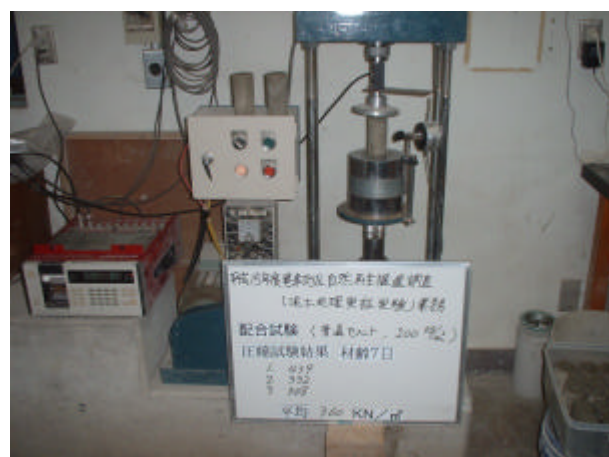
写真 4-3-9 一軸圧縮試験状況 (普通セメント、200kg/m³、材齢 7 日)
