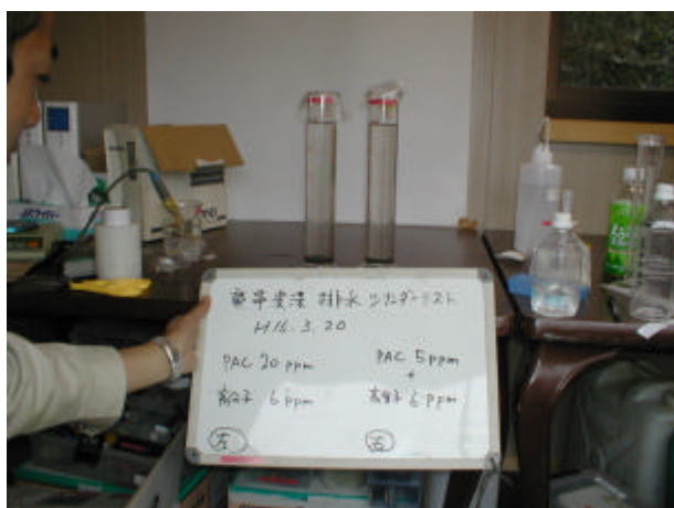
写真 3-5-41 テーブルテスト状況 (凝集テスト)
