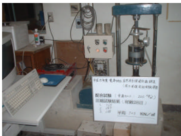
写真 4-3-15 一軸圧縮試験状況 (普通セメント、200kg/m³、材齢 28 日)
