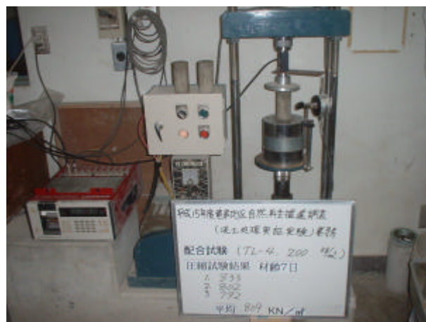
写真 4-3-10 一軸圧縮試験状況 (セメント系固化材、200kg/m³、材齢 7 日)
