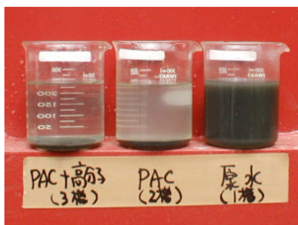
写真 3-5-24 処理状況 (右：原水、左：処理水, PAC+高分子凝集剤)
