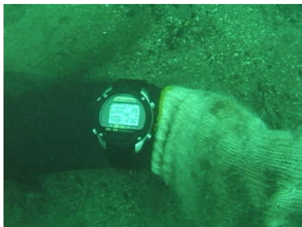
写真 2-5-14 潜士による水深の確認
