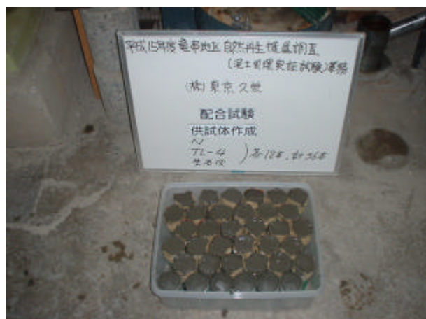
写真 4-3-7 供試体作成状況 (モールド：φ5×10cm)
