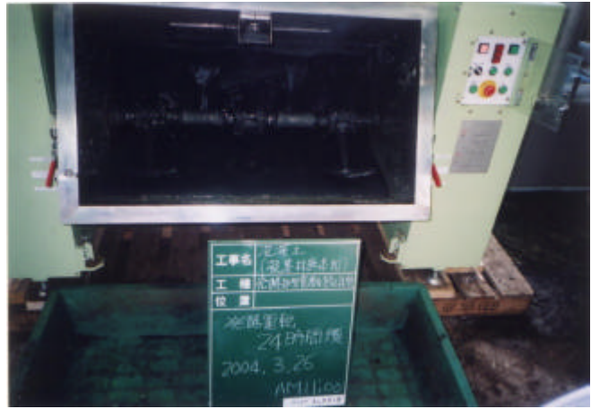
写真 4-4-10 発酵処理状況 (無薬注浚渫土・24 時間後)
