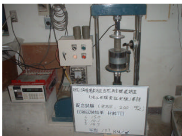
写真 4-3-11 一軸圧縮試験状況 (生石灰、200kg/m³、材齢 7 日)
