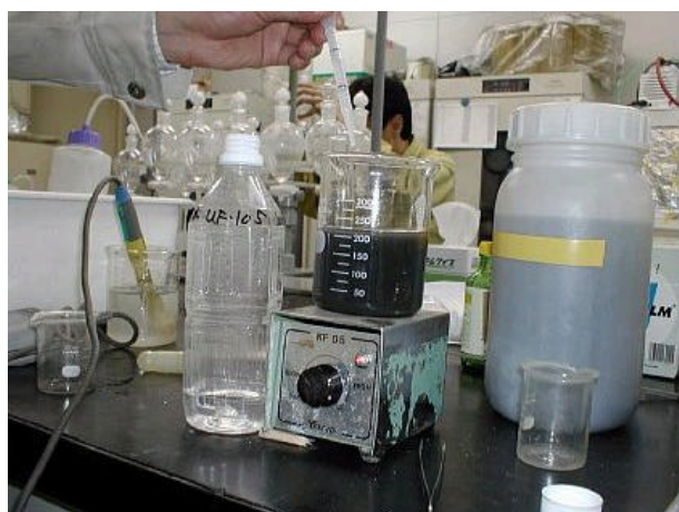
写真 3-4-3 凝集テスト状況
