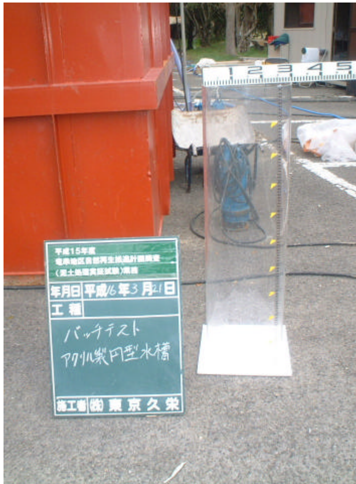
写真 3-6-1 アクリル製円形水槽 (φ300mm×H1000mm)
