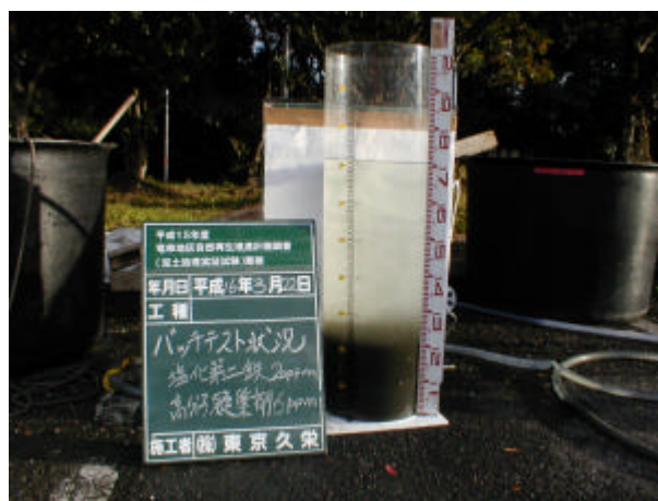
写真 3-6-6 バッチテスト状況 (塩化第二鉄 20ppm+高分子凝集剤 6ppm)
