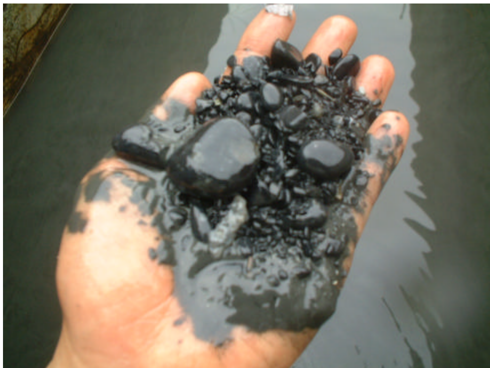
写真 2-3-26 水处理水槽堆積物（礫・玉石）
