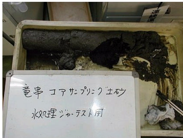
写真 3-4-1 竜串湾堆積土のコアサンプル (全体)
