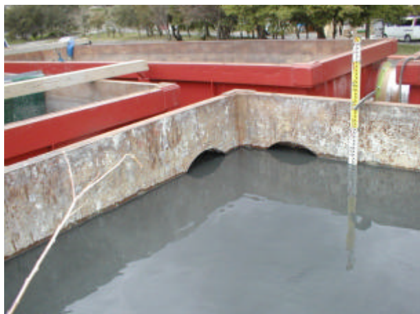
写真 3-5-13 水面上昇による排水流量の測定
