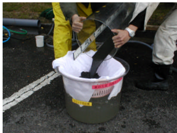
写真 3-6-8 フロック重力脱水状況
