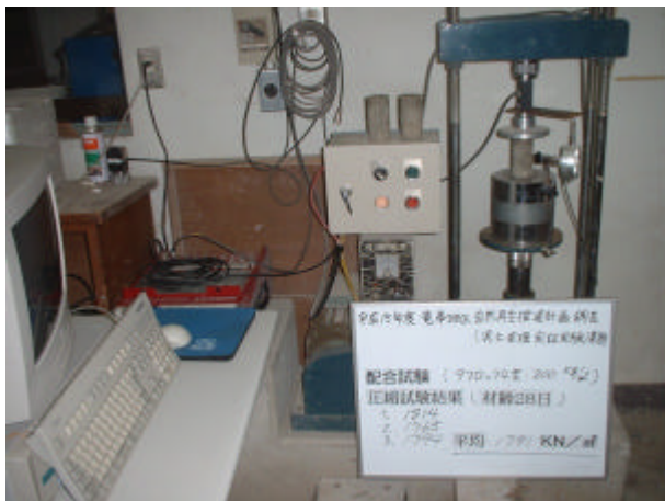
写真 4-3-16 一軸圧縮試験状況 (セメント系固化材、200kg/m³、材齢 28 日)
