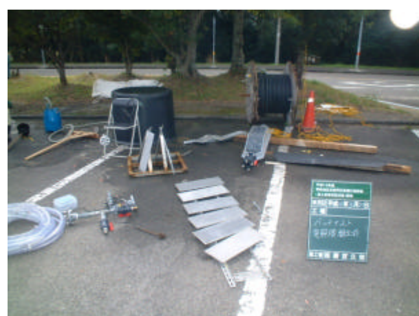
写真 3-6-16 電解装置組立て前
