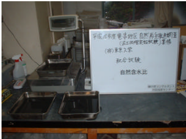
写真 4-3-1 自然含水比測定
