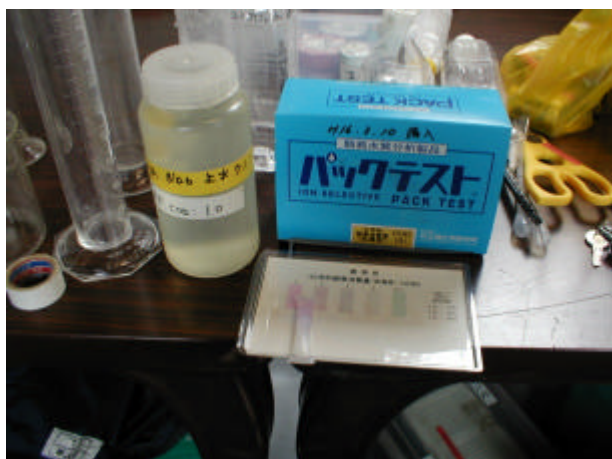
写真 3-5-37 上澄み水モニタリング (PAC テスト、COD 分析状況)
