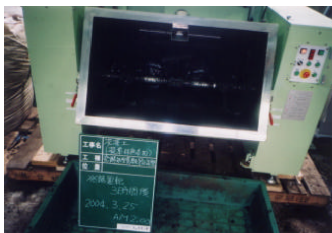
写真 4-4-17 発酵処理状況 (薬注浚渫土・3 時間後)
