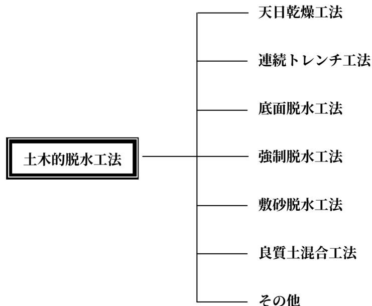
図 4-2-1 土木的脱水工法
