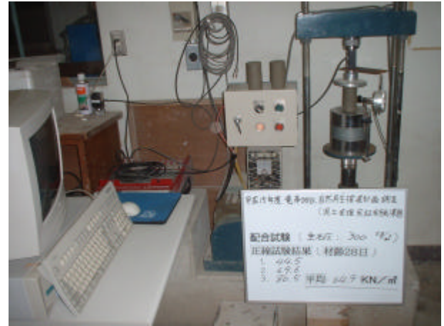
写真 4-3-20 一軸圧縮試験状況 (生石灰、300kg/m 3 、材齢 28 日)
