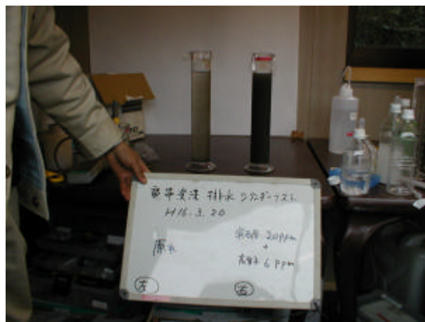
写真 3-5-40 テーブルテスト状況 (凝集テスト)
