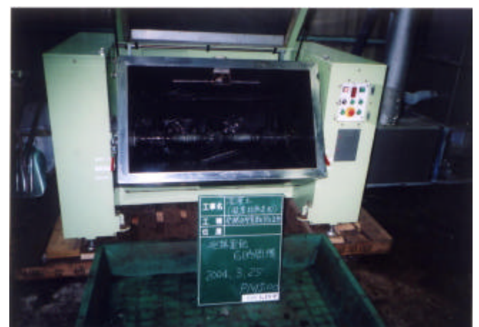
写真 4-4-18 発酵処理状況 (薬注浚渫土・6 時間後)
