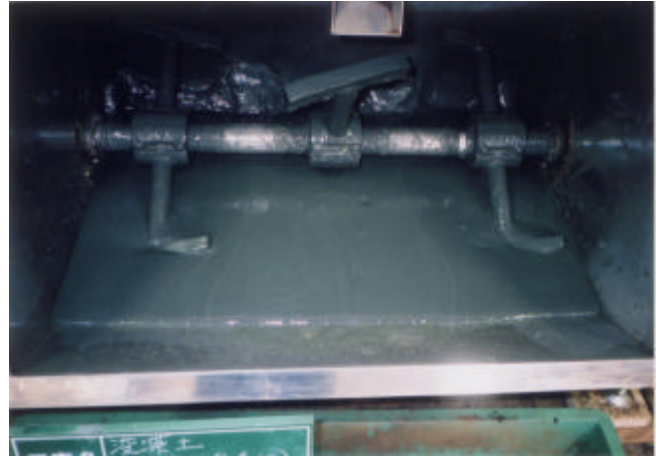
写真 4-4-8 発酵処理状況 (拡大) (無薬注浚渫土・3 時間後)
