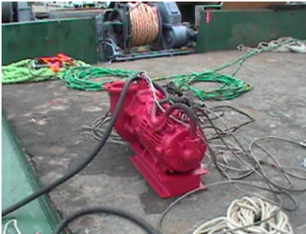
写真 2-3-17 排砂ポンプ (150A, 22kW, 200V)
