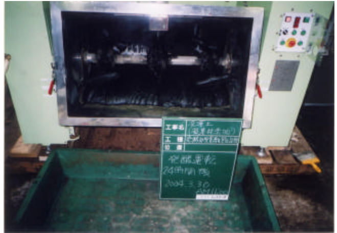
写真 4-4-20 発酵処理状況 （薬注浚渫土・24 時間後）
