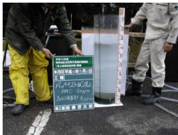
写真 3-6-3 バッチテスト状況 (PAC20ppm＋高分子凝集剤 6ppm)
