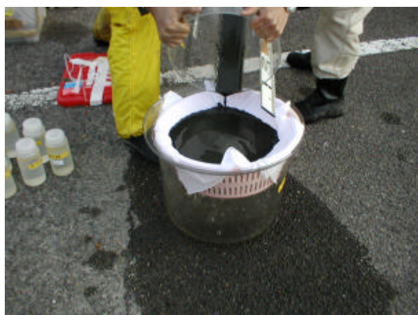
写真 3-6-9 フロック重力脱水状況
