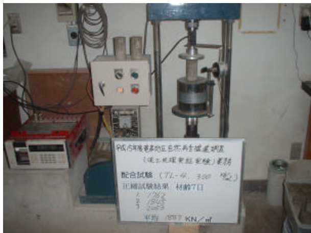
写真 4-3-13 一軸圧縮試験状況 (セメント系固化材、300kg/m³、材齢 7 日)
