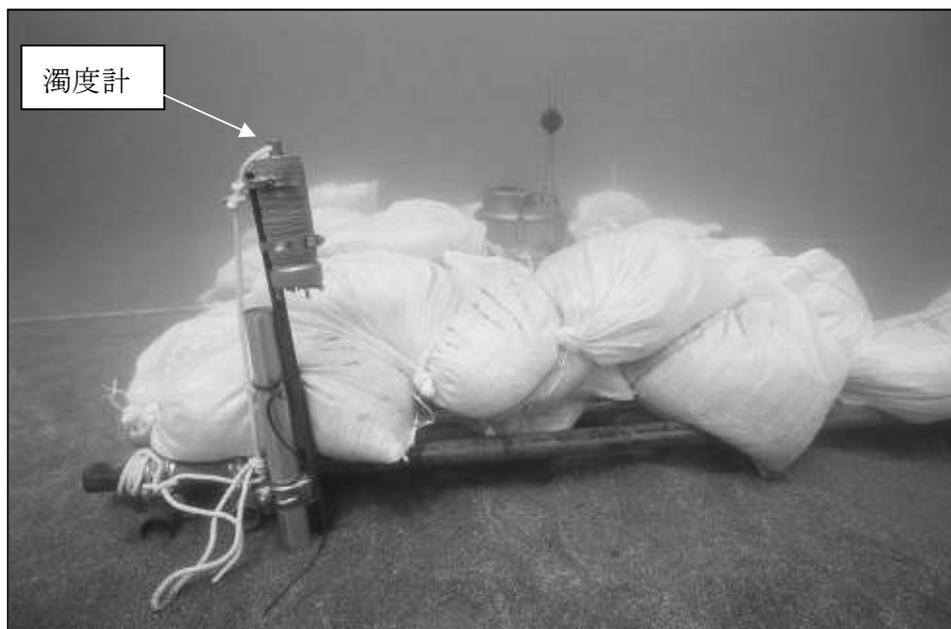
図 4 - 2 0 . 濁度計の設置状況
