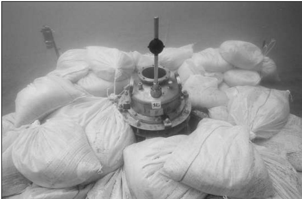
图 4 - 1 7 . 波高計設置狀況
