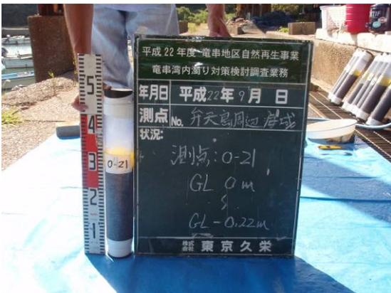
写真 123 弁天島 O-21 柱状採泥試料
