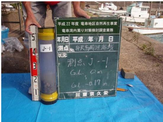
写真 49 弁天島 J-1 柱状採泥試料
