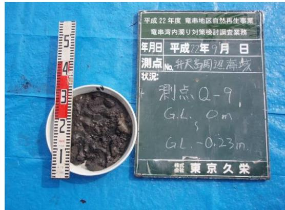
写真 126 弁天島 Q-9 柱状採泥試料 状態
