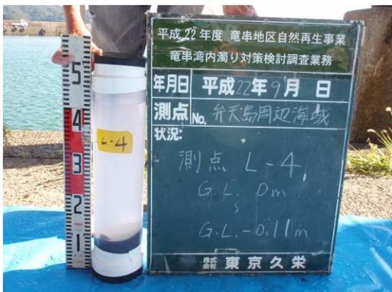
写真 75 弁天島 L-4 柱状採泥試料
