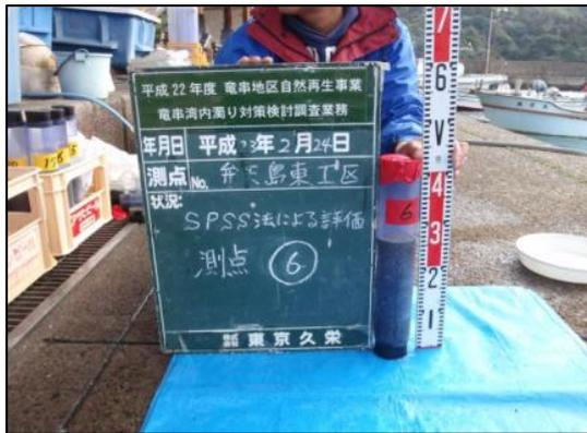
写真 11 測点⑥ 柱状採泥試料
