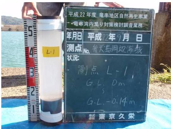
写真 69 弁天島 L-1 柱状採泥試料
