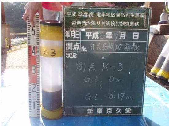
写真 59 弁天島 K-3 柱状採泥試料
