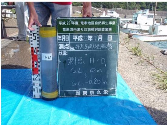
写真 39 弁天島 H-0 柱状採泥試料
