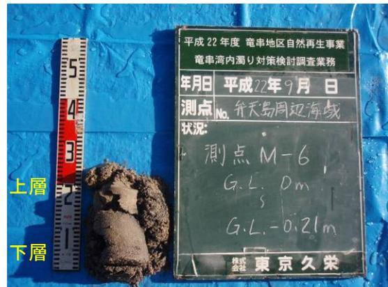
写真 92 弁天島 M-6 柱状採泥試料 状態
