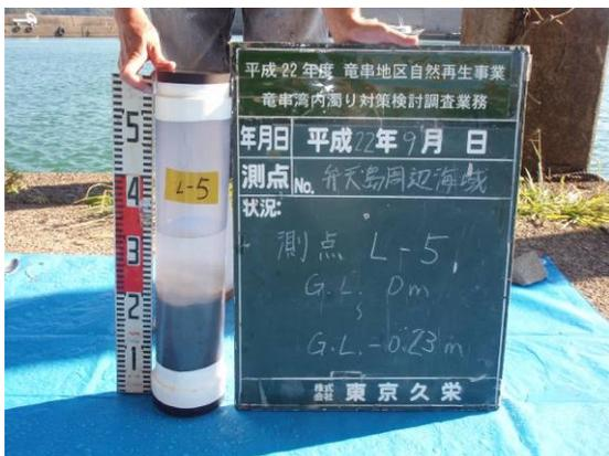
写真 77 弁天島 L-5 柱状採泥試料
