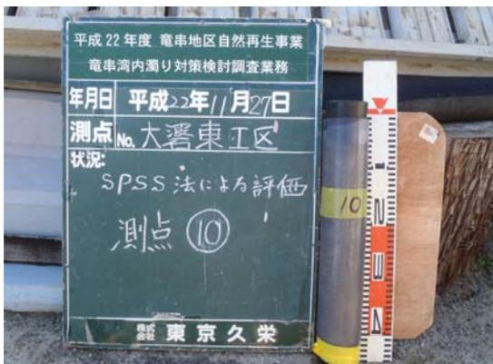
写真 19 測点⑩ 柱状採泥試料
