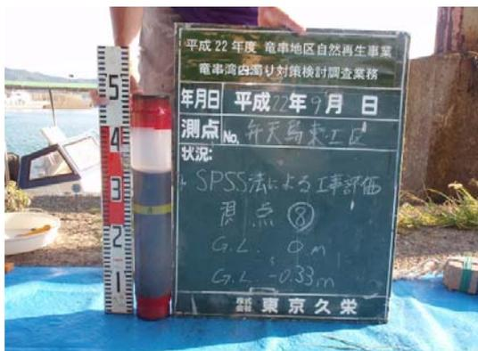
写真 15 測点⑧ 柱状採泥試料
