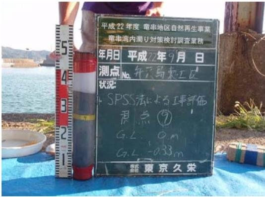
写真 17 測点⑨ 柱状採泥試料
