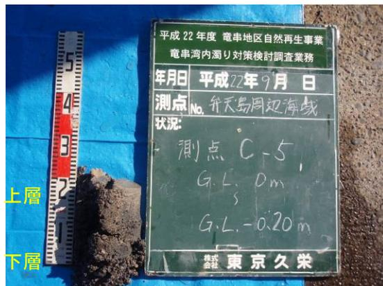
写真 18 弁天島 C-5 柱状採泥試料 状態
