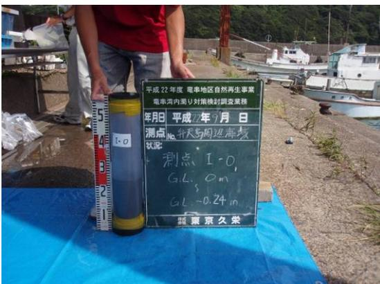
写真 45 弁天島 I-0 柱状採泥試料
