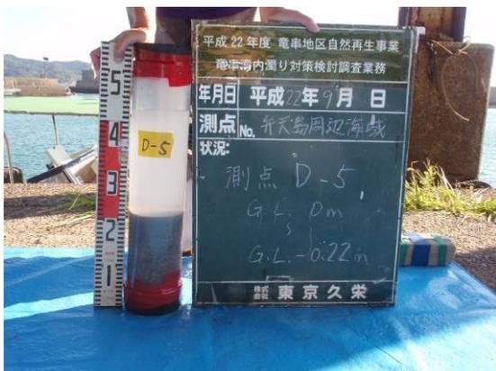
写真 23 弁天島 D-5 柱状採泥試料
