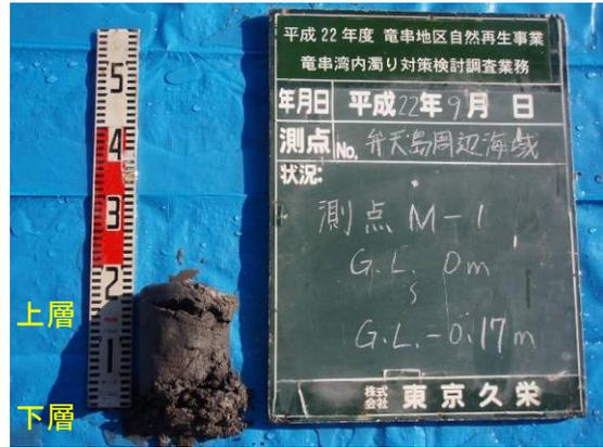
写真 82 弁天島 M-1 柱状採泥試料 状態
