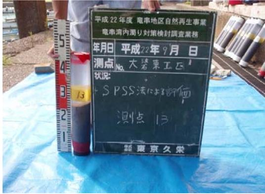
写真 25 測点⑬ 柱状採泥試料
