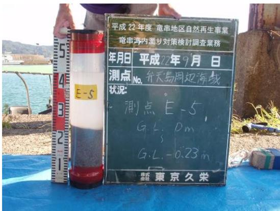
写真 29 弁天島 E-5 柱状採泥試料
