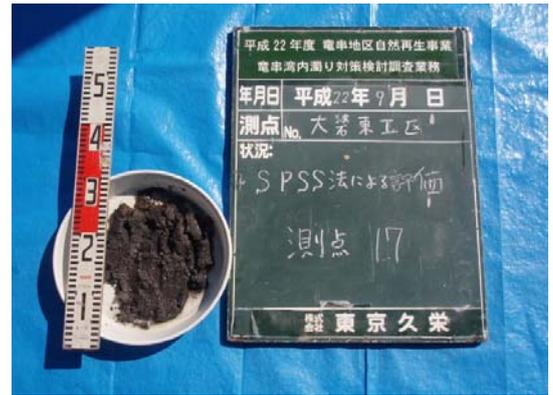
写真 34 測点⑰ 柱状採泥試料 状態
