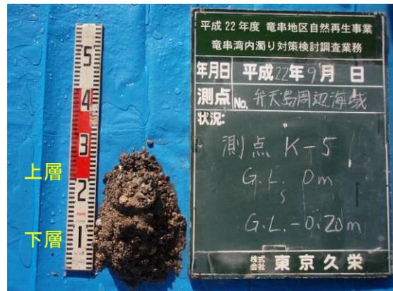
写真 64 弁天島 K-5 柱状採泥試料 状態
