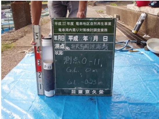
写真 113 弁天島 O-11 柱状採泥試料
