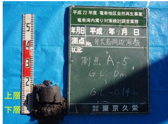
写真 6 弁天島 A-5 柱状採泥試料 状態
