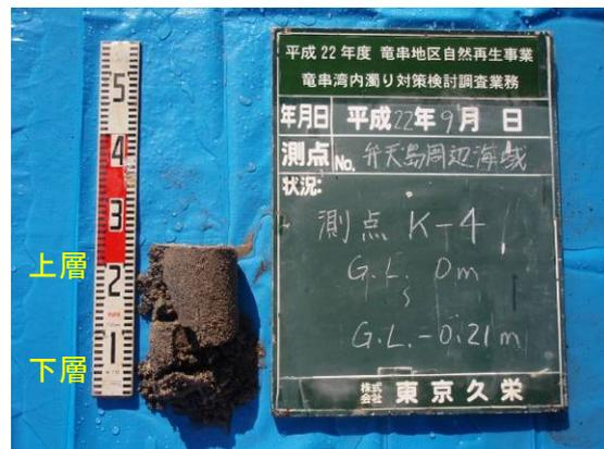
写真 62 弁天島 K-4 柱状採泥試料 状態
