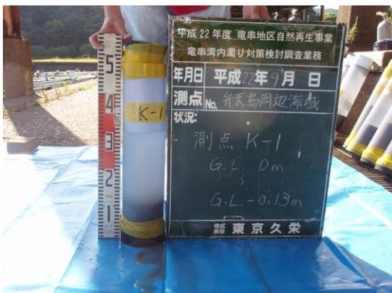
写真 55 弁天島 K-1 柱状採泥試料
