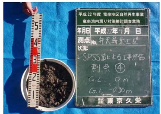
写真 8 測点④ 柱状採泥試料 状態
