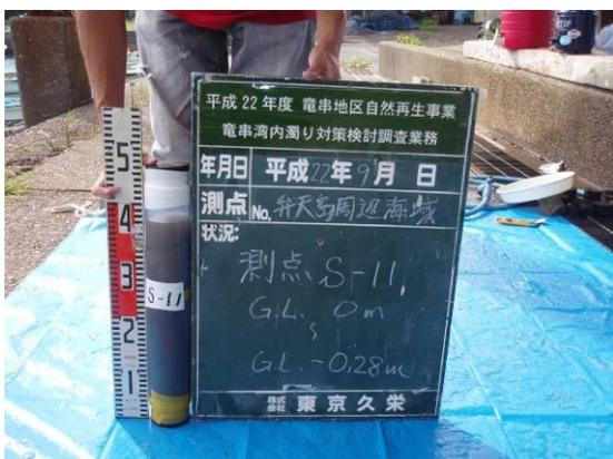
写真 133 弁天島 S-11 柱状採泥試料
