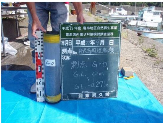
写真 33 弁天島 G-0 柱状採泥試料
