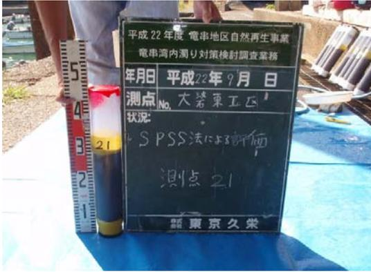
写真 41 測点21 柱状採泥試料
