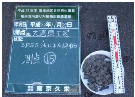
写真 30 測点⑮ 柱状採泥試料 状態
