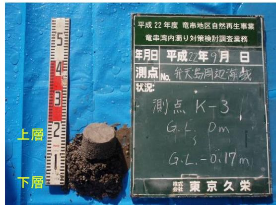
写真 60 弁天島 K-3 柱状採泥試料 状態
