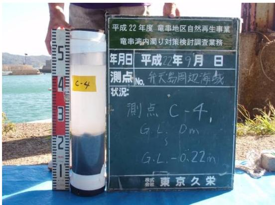
写真 15 弁天島 C-4 柱状採泥試料
