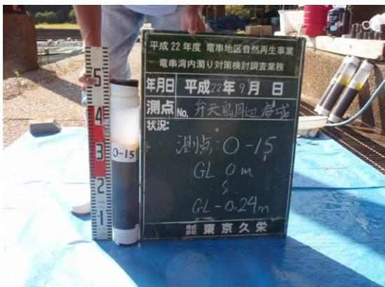
写真 117 弁天島 O-15 柱状採泥試料
