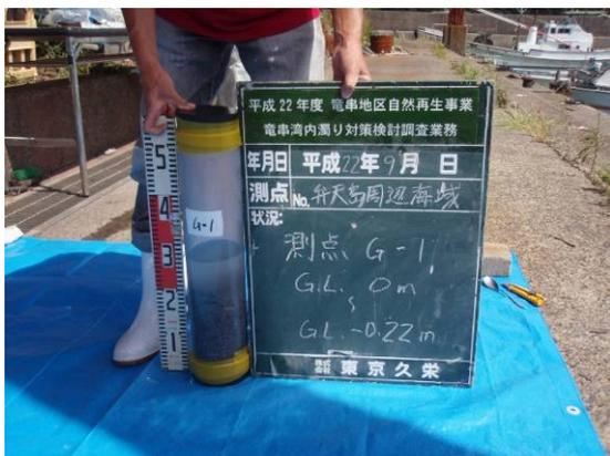
写真 35 弁天島 G-1 柱状採泥試料
