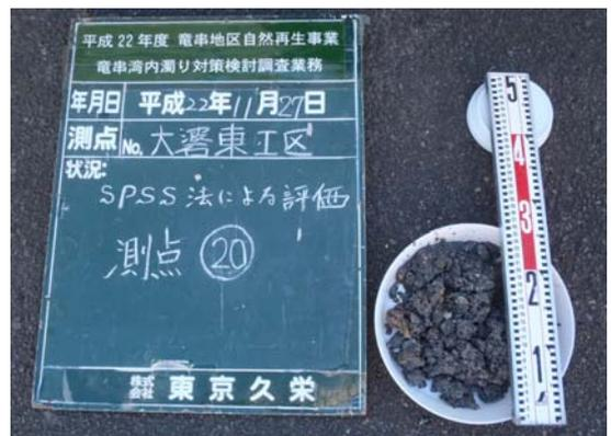
写真 40 測点②0 柱状採泥試料 状態
