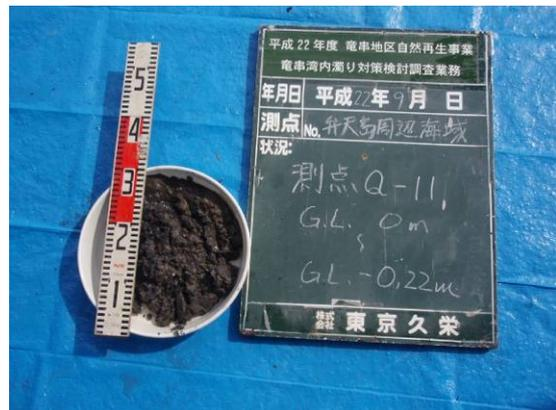
写真 128 弁天島 Q-11 柱状採泥試料 状態
