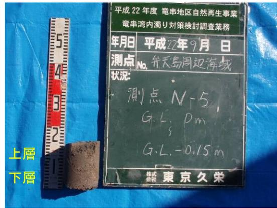
写真 106 弁天島 N-5 柱状採泥試料 状態
