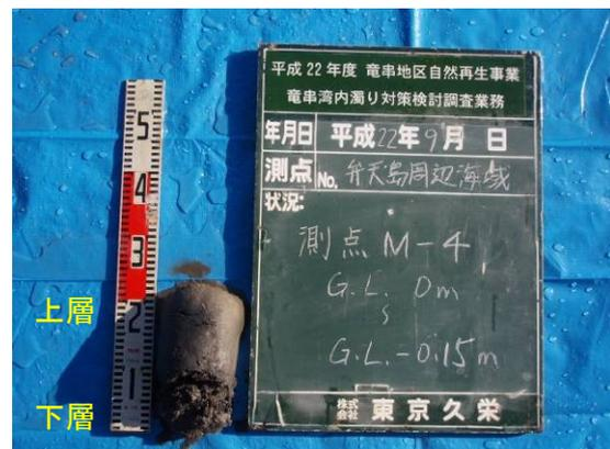
写真 88 弁天島 M-4 柱状採泥試料 状態
