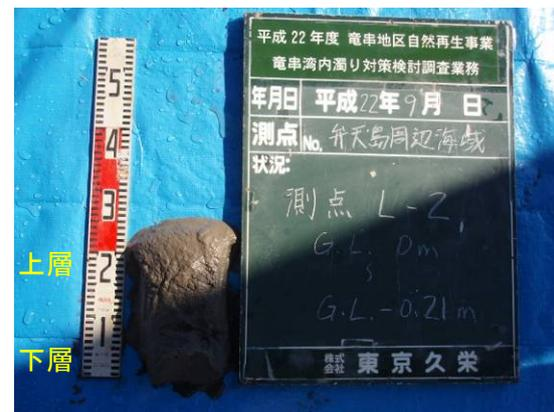
写真 72 弁天島 L-2 柱状採泥試料 状態
