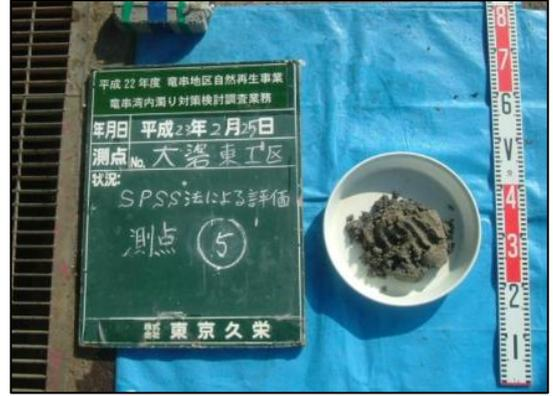
写真 10 測点⑤ 柱状採泥試料 状態
