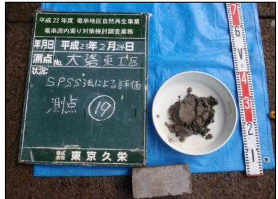
写真 38 測点⑲ 柱状採泥試料 状態
