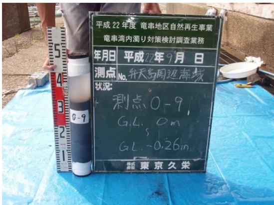
写真 111 弁天島 O-9 柱状採泥試料
