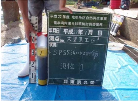
写真 1 測点① 柱状採泥試料
