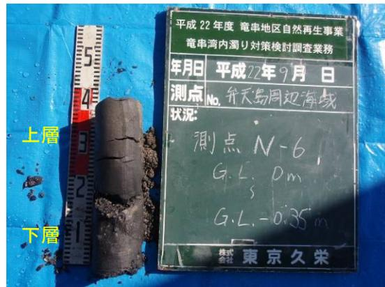
写真 108 弁天島 N-6 柱状採泥試料 状態
