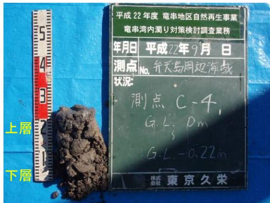
写真 16 弁天島 C-4 柱状採泥試料 状態
