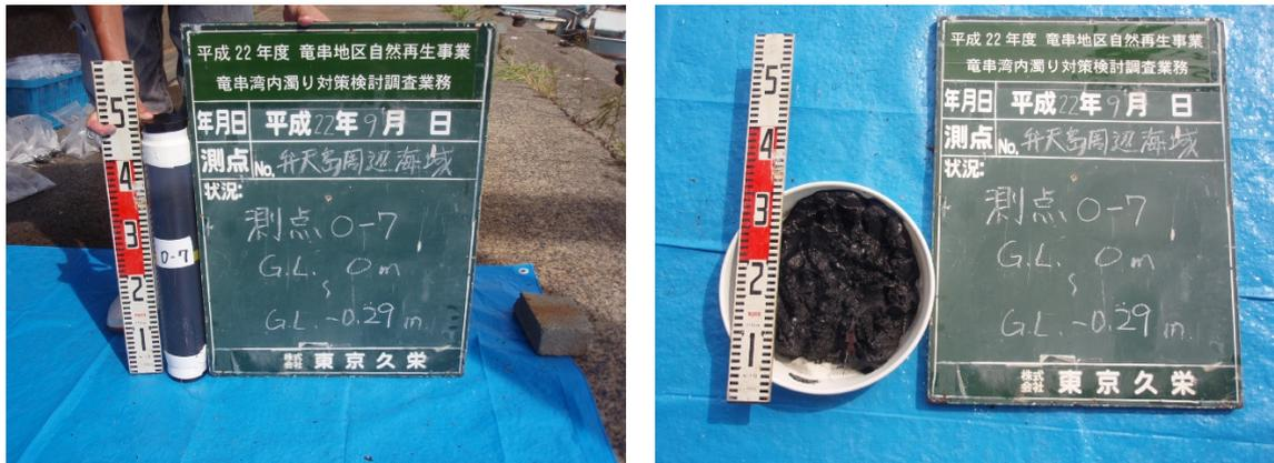
写真 2-3-8 0-7 葉片・木片、礫混じり泥土の堆積
