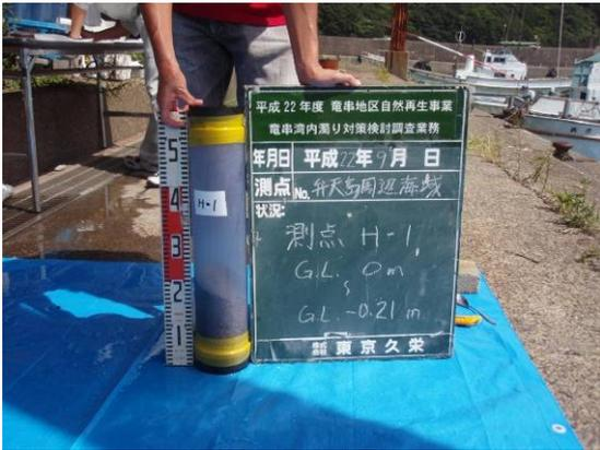
写真 41 弁天島 H-1 柱状採泥試料
