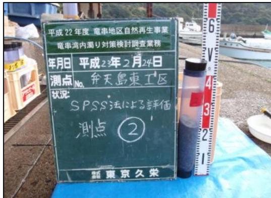
写真 3 測点② 柱状採泥試料
