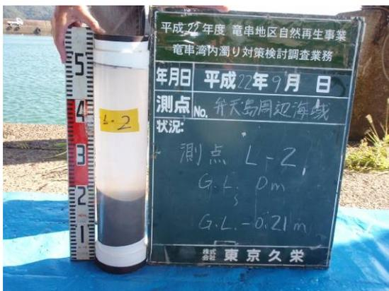
写真 71 弁天島 L-2 柱状採泥試料
