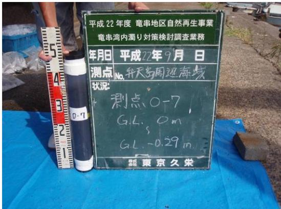
写真 109 弁天島 O-7 柱状採泥試料
