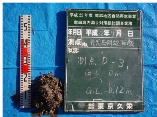
写真 20 弁天島 D-3 柱状採泥試料 状態
