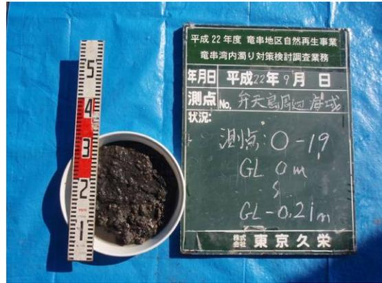
写真 122 弁天島 O-19 柱状採泥試料 状態
