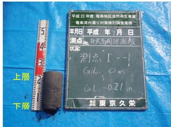
写真 44 弁天島 I--1 柱状採泥試料 状態
