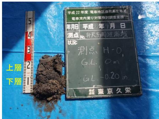
写真 40 弁天島 H-0 柱状採泥試料 状態
