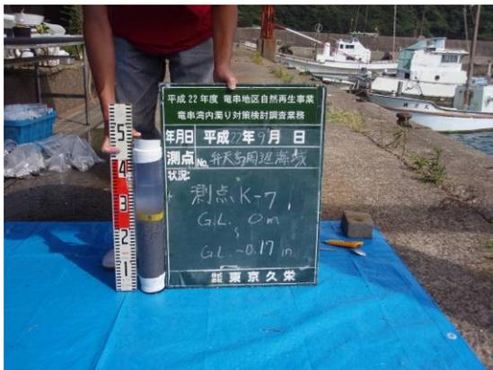
写真 67 弁天島 K-7 柱状採泥試料
