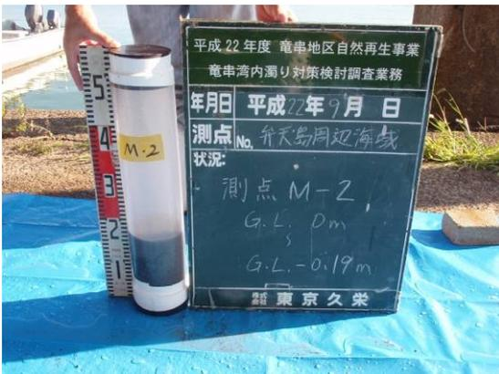
写真 83 弁天島 M-2 柱状採泥試料
