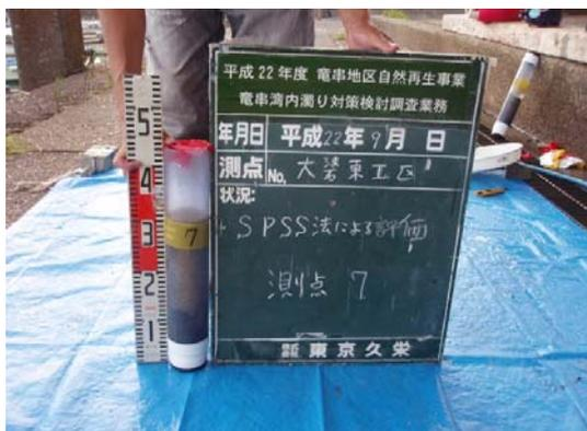
写真 13 測点⑦ 柱状採泥試料
