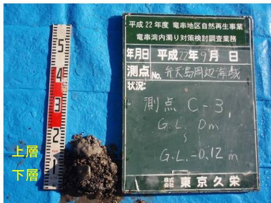
写真 14 弁天島 C-3 柱状採泥試料 状態
