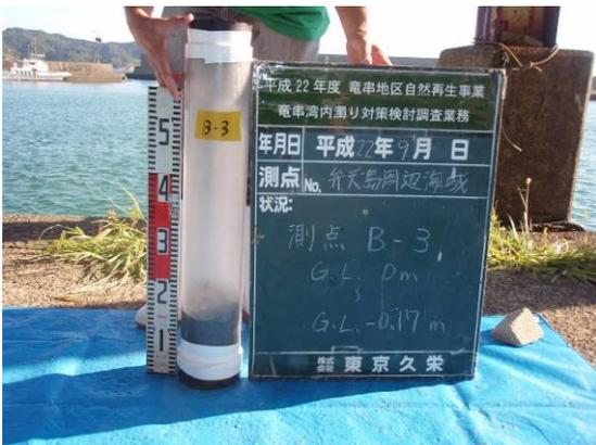
写真 7 弁天島 B-3 柱状採泥試料
