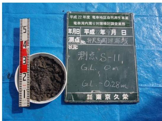
写真 134 弁天島 S-11 柱状採泥試料 状態
