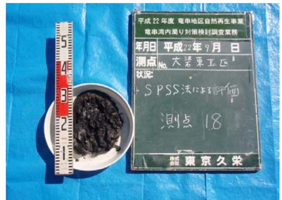
写真 36 測点⑱ 柱状採泥試料 状態
