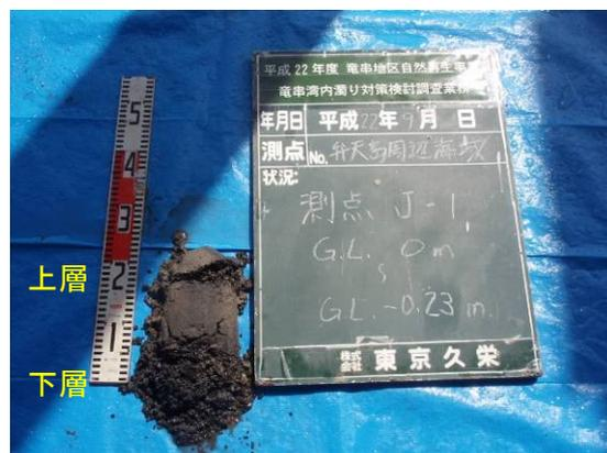
写真 54 弁天島 J-1 柱状採泥試料 状態
