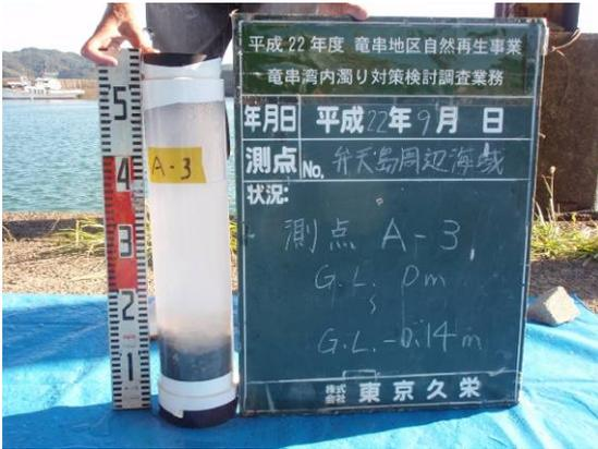
写真 1 弁天島 A-3 柱状採泥試料
