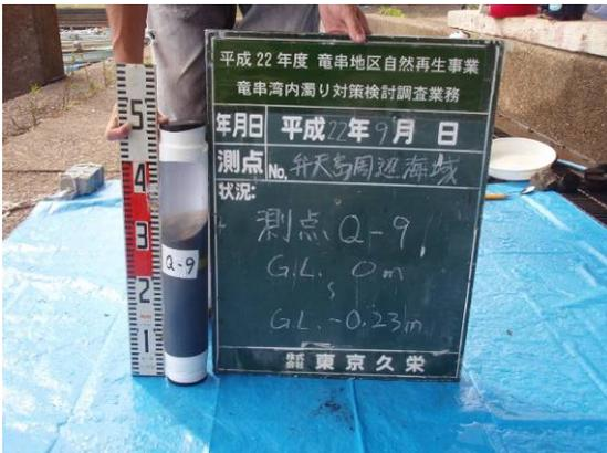
写真 125 弁天島 Q-9 柱状採泥試料
