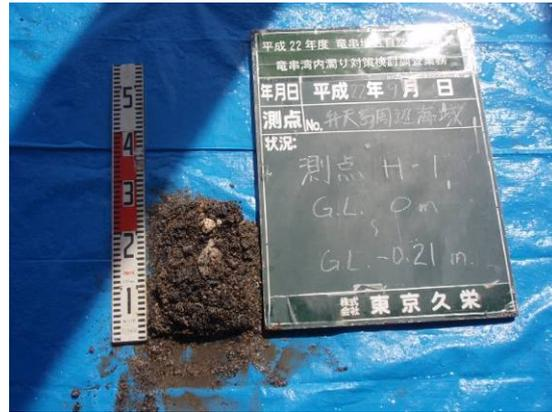
写真 42 弁天島 H-1 柱状採泥試料 状態
