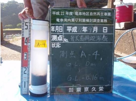
写真 3 弁天島 A-4 柱状採泥試料
