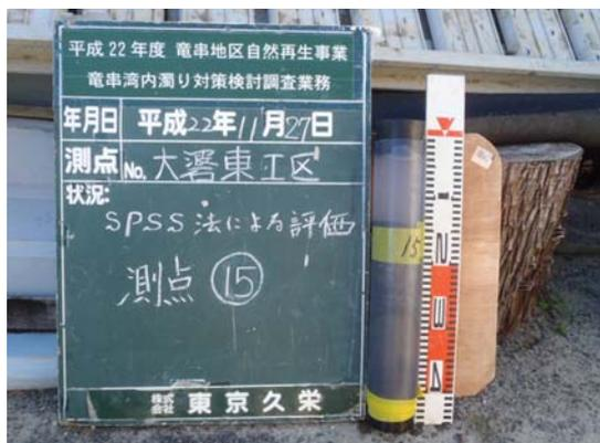
写真 29 測点⑮ 柱状採泥試料
