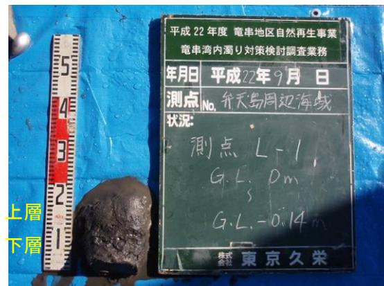
写真 70 弁天島 L-1 柱状採泥試料 状態
