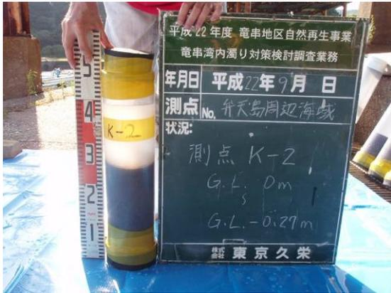
写真 57 弁天島 K-2 柱状採泥試料
