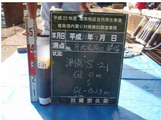
写真 135 弁天島 S-21 柱状採泥試料
