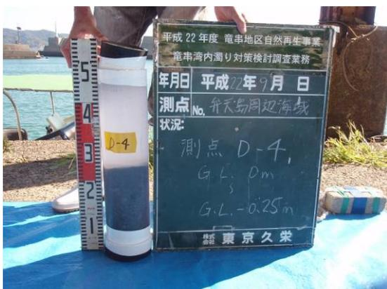
写真 21 弁天島 D-4 柱状採泥試料
