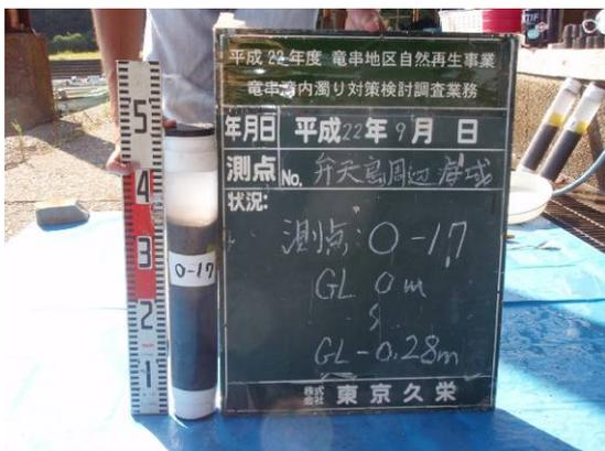
写真 119 弁天島 O-17 柱状採泥試料
