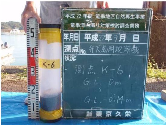
写真 65 弁天島 K-6 柱状採泥試料
